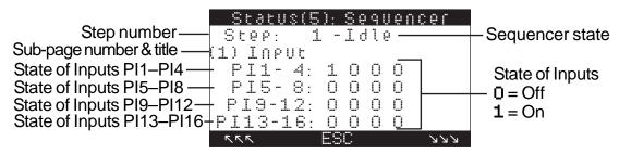
**Figure 5-9.** *Sequencer Inputs*
